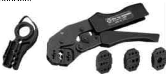
Descascador de cabos coaxiais (à esquerda) e alicate de crimpagem.
